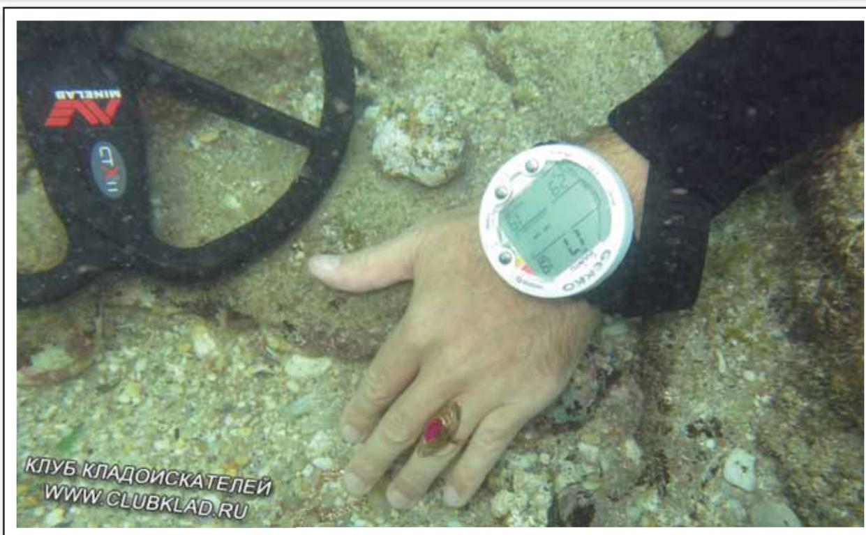
Металлоискатель в соленой воде имеет нейтральную плавучесть, что позволяет без проблем работать с ним у дна. Он стоит как поплавок: не выплывает на поверхность и не падает на дно.
