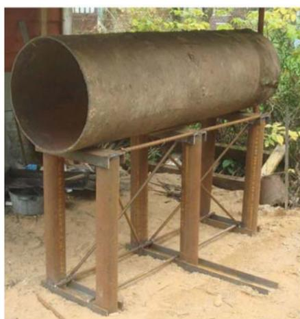
Итак, для изготовления печи была взята труба большого диаметра. Необязательно, чтобы это была обязательно новая труба, можно взять б/у. Длина трубы такая, чтобы в нее с запасом входило любое ружье или сабля, помещенная в реактор.
