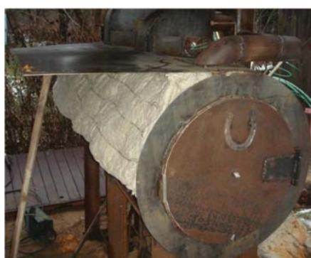
Утепление печи. Наша печь не для обогрева, а для создания оптимально высокой температуры внутри печи (напомним, это 900-1000 градусов) и разогрева помещенного в нее реактора. Для достижения высоких внутренних температур печь «утепляем» минеральной ватой.
