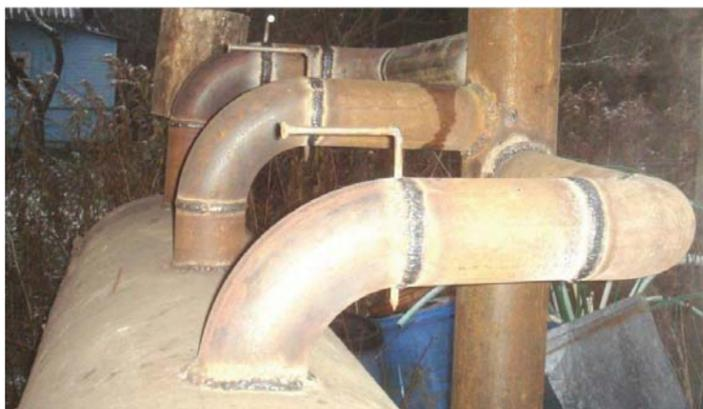
На патрубки устанавливаем заслонки, которые дают возможность снизить тягу и тем самым увеличить эффективное время работы печи, не открывая заслонку для подкладывания дров. Главное в любой печи — хорошая тяга, которая обеспечивается высокой прямой трубой. Чем выше труба, тем лучше тяга. Диаметр трубы не должен быть меньше 180 мм.
