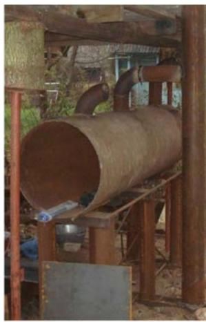
Для улучшения тяги и равномерного прогрева длинной печи установлены три воздуховода.
